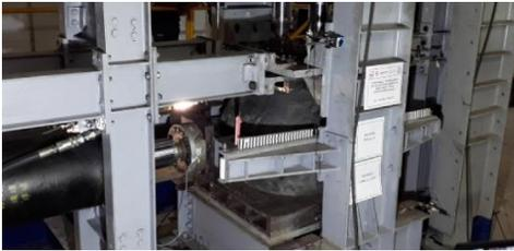
Compuesto de fibra de poliéster y caucho que aísla la estructura del movimiento sísmico. Se puede elaborar en diferentes formatos y no requiere de núcleo de plomo, por sus características y rendimiento, elimina el uso de platinas y pernos de anclaje en instalación; además mejora la respuesta sísmica de edificios de baja altura (entre 3 y 5 pisos).
