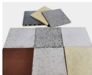
Proceso de fabricación de placas o baldosas con residuos de poliuretano, cuyos paneles y/o ladrillos conservan las mismas propiedades de la resina original, como el confort, aislantes térmicas, aislante acústico, liviano y adaptable a cualquier tipo de terreno.
