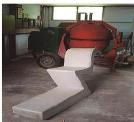
Metodología que permite la obtención de hormigones autocompactables de resistencia media (HAC-RM) sin incluir adiciones minerales en la mezcla, con lo cual se aumenta la productividad y aplicabilidad en diversas obras civiles; optimizando el uso de los componentes convencionales de un hormigón convencional (HC).
